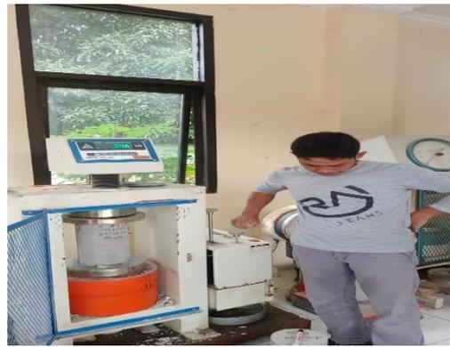
**Gambar 1** Pengujian Kuat Tekan Beton
