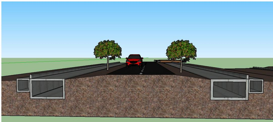
**Gambar 12.** Tiga dimesi saluran utama
